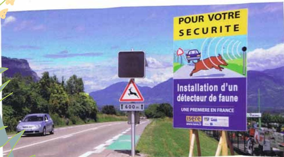
*C'est un appareil qui permet de détecter un animal à un endroit donné et indique aux automobilistes de ralentir et de sauver des vies d'un côté comme de l'autre. Ils localisent l'arrivée d'un animal grâce à ses mouvements et sa chaleur. Cela déclenche le panneau qui clignote de chaque côté de la route avertissant les conducteurs qui doivent ralentir.*
