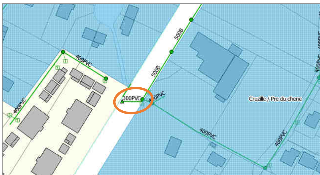
Fig. 4-a : Localisation du tronçon à renforcer
